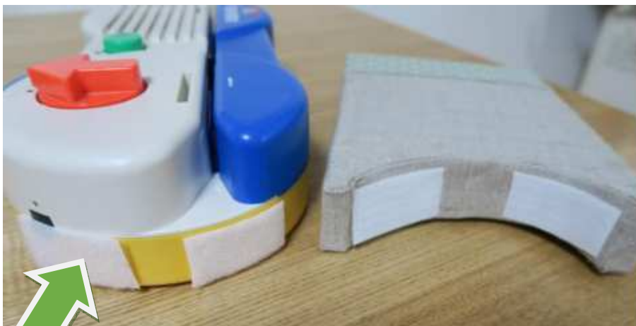
⑩マジックテープを付けて完成!! ※Playmate 側に汚れが付きにくい凹を貼る
